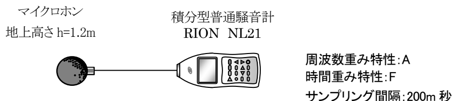
図 2.3 測定機器の構成図(騒音レベル)
