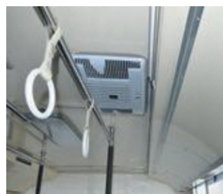
前後2カ所にプラズマクラスターを増設し、室内の空気清浄を保つ
