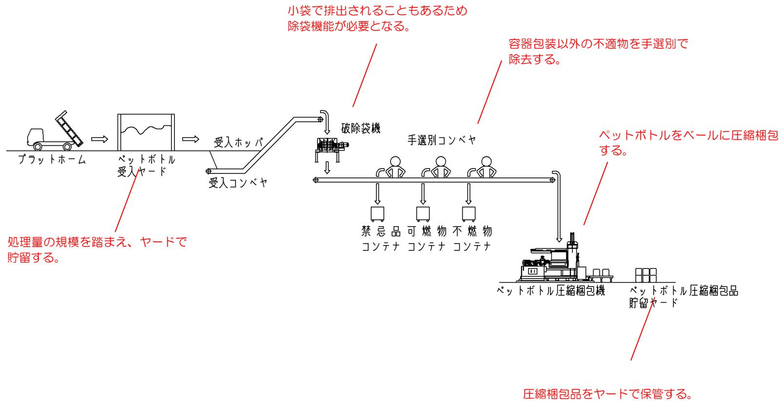
図 2.4-9 ペットボトル処理フロー（参考）
