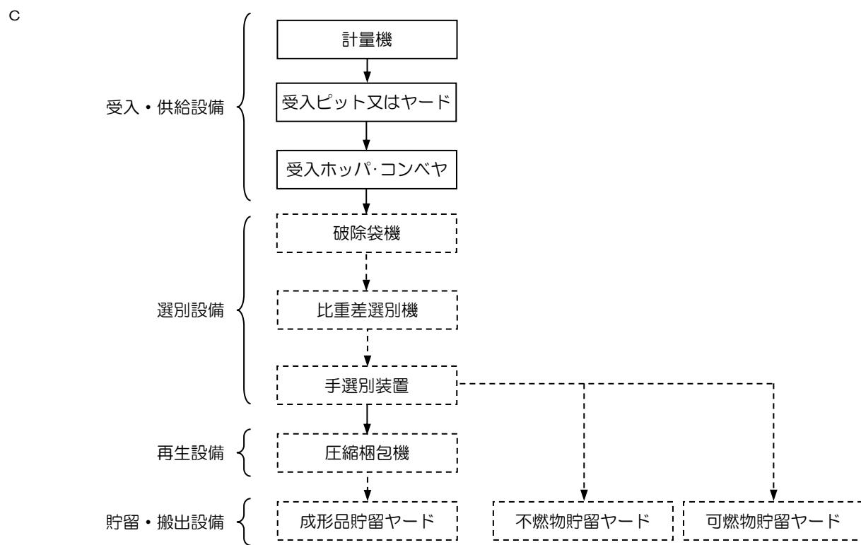
図 2.4-4 プラスチックごみ処理フロー（参考）※実線：既存施設あり、点線：新規導入
