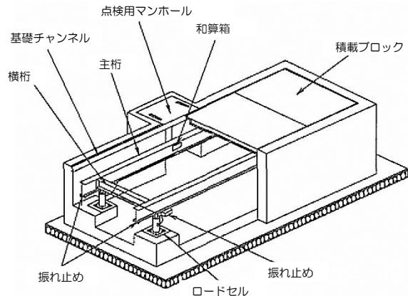
図 2.4-1 ロードセル式計量機（ピット式）
