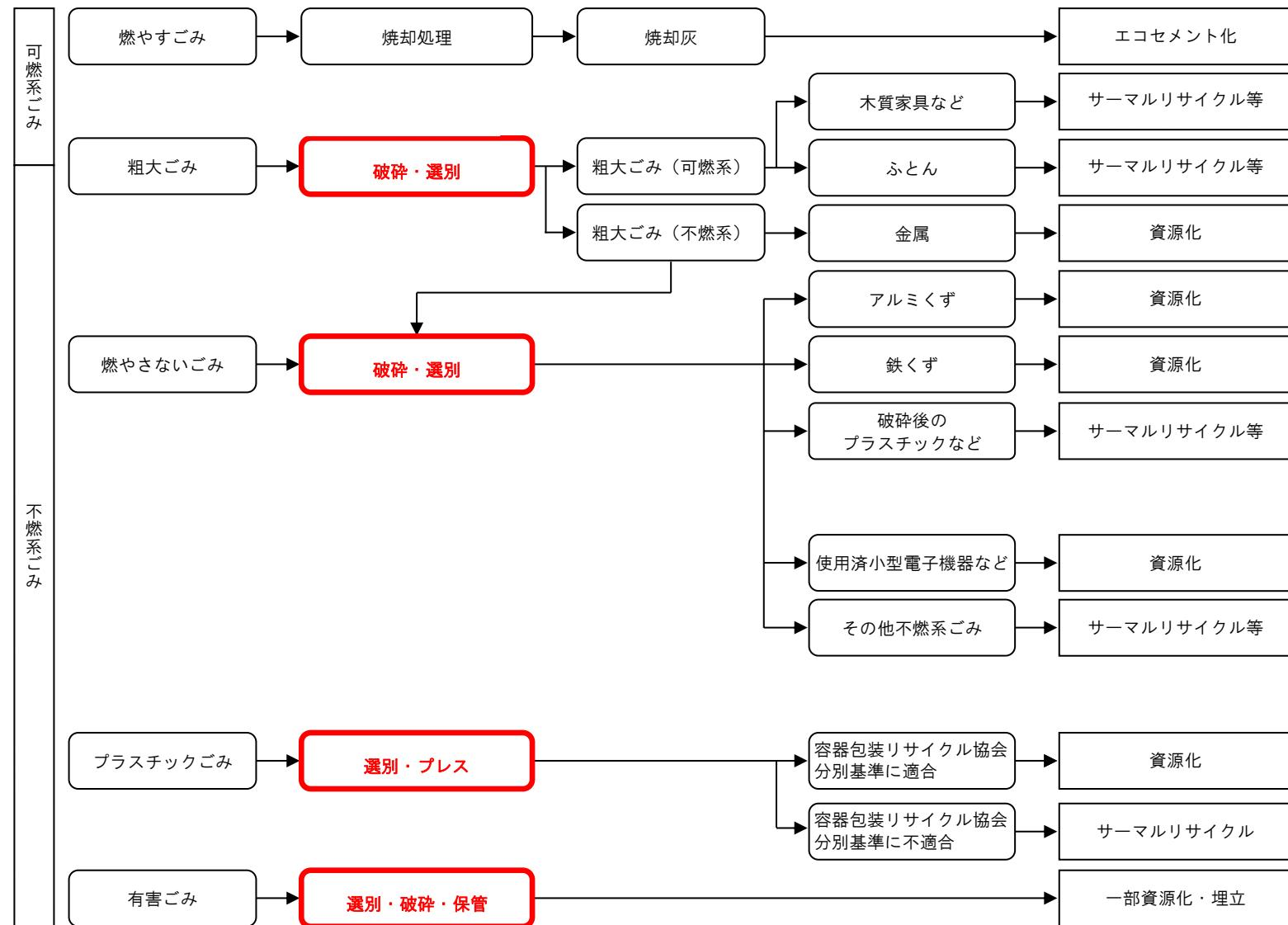
図 1.3-1 ごみ処理フロー（計画案：不燃・粗大ごみを破碎・選別処理する施設を設置する場合：その1）
