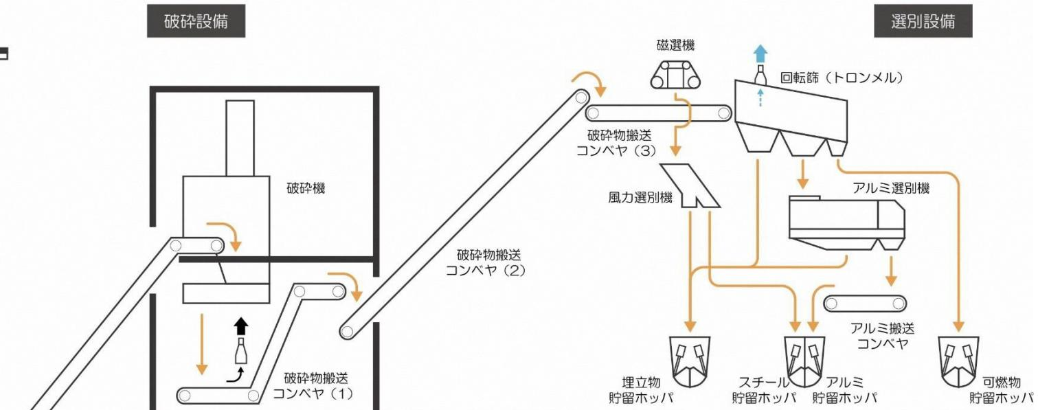
図 1.2-1 中間処理場 処理フロー
