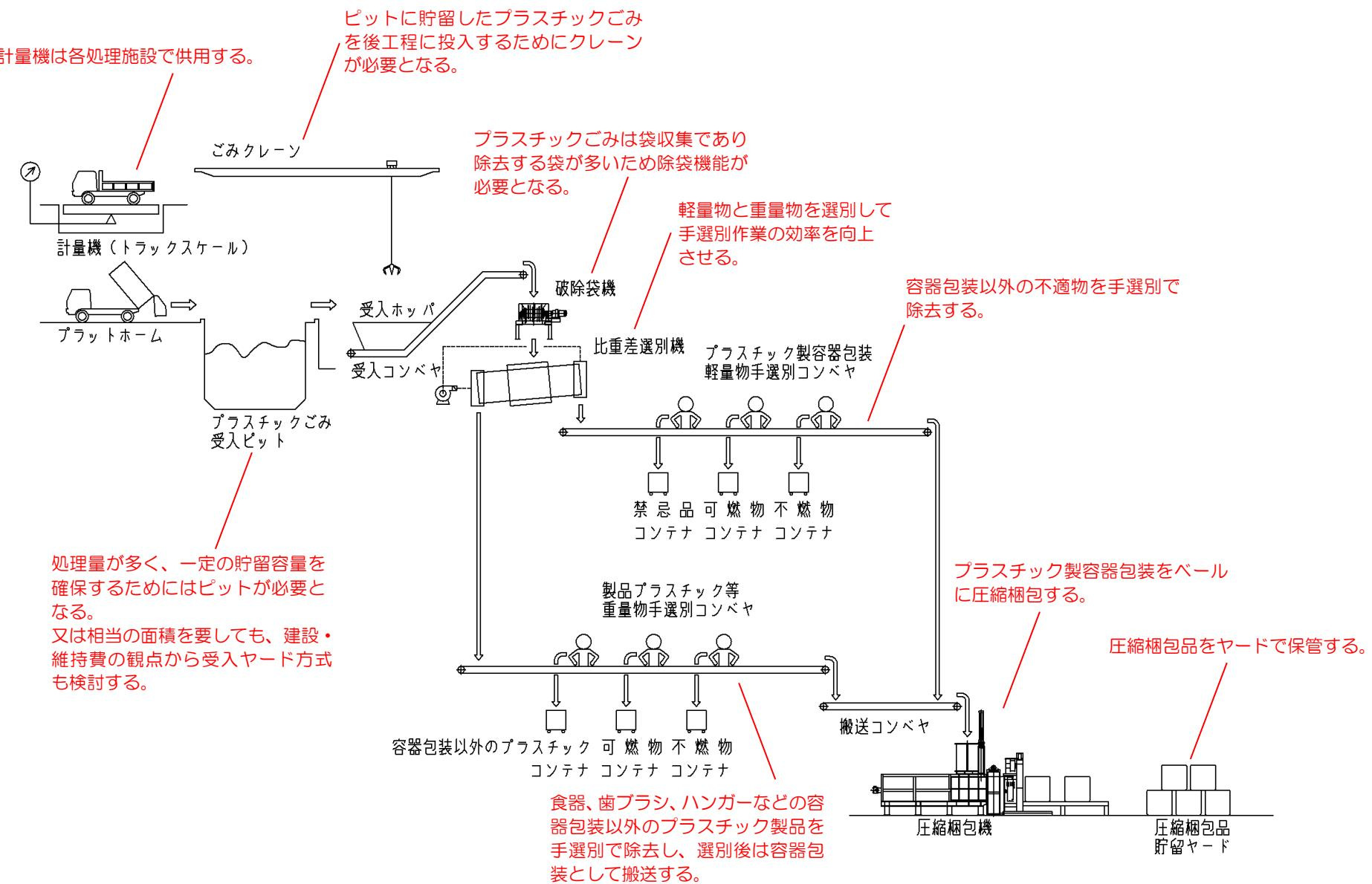
図 2.4-8 プラスチックごみ処理フロー（参考）
