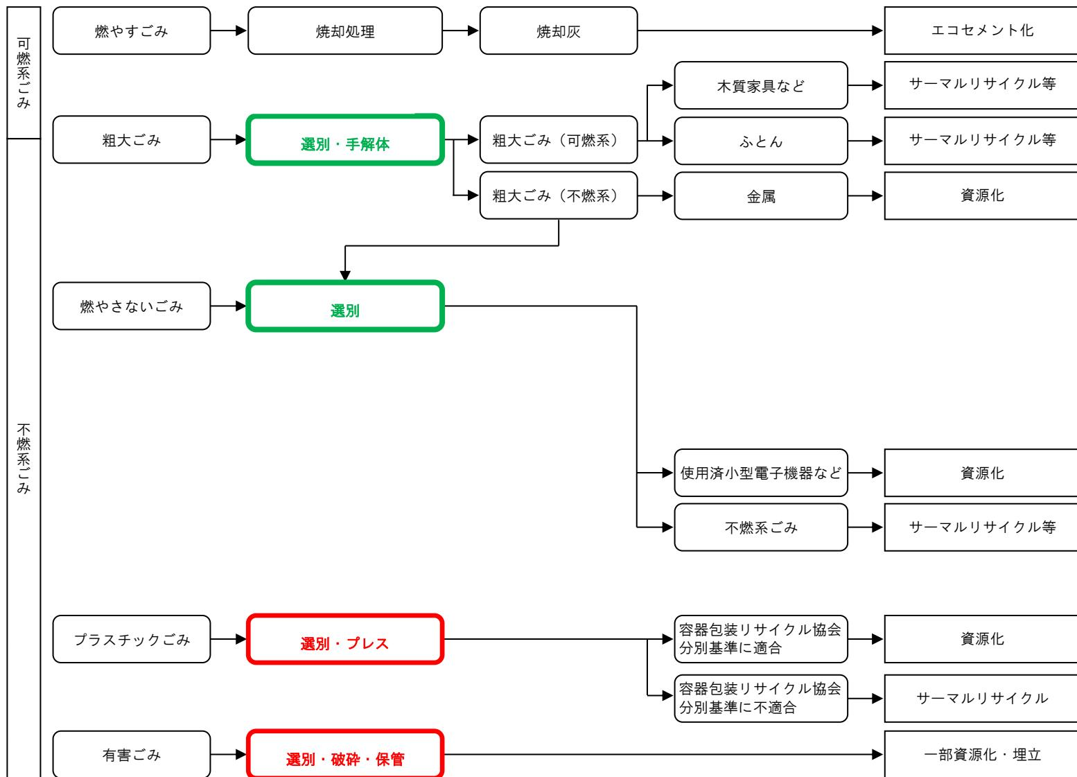
図 1.3-2 ごみ処理フロー（計画案：不燃・粗大ごみを民間処理施設に委託処理する場合：その 1）
