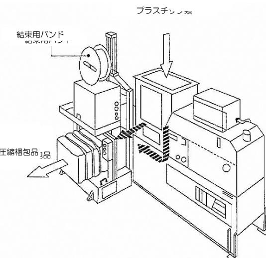
図 2.4-3 プラスチック類圧縮梱包機
