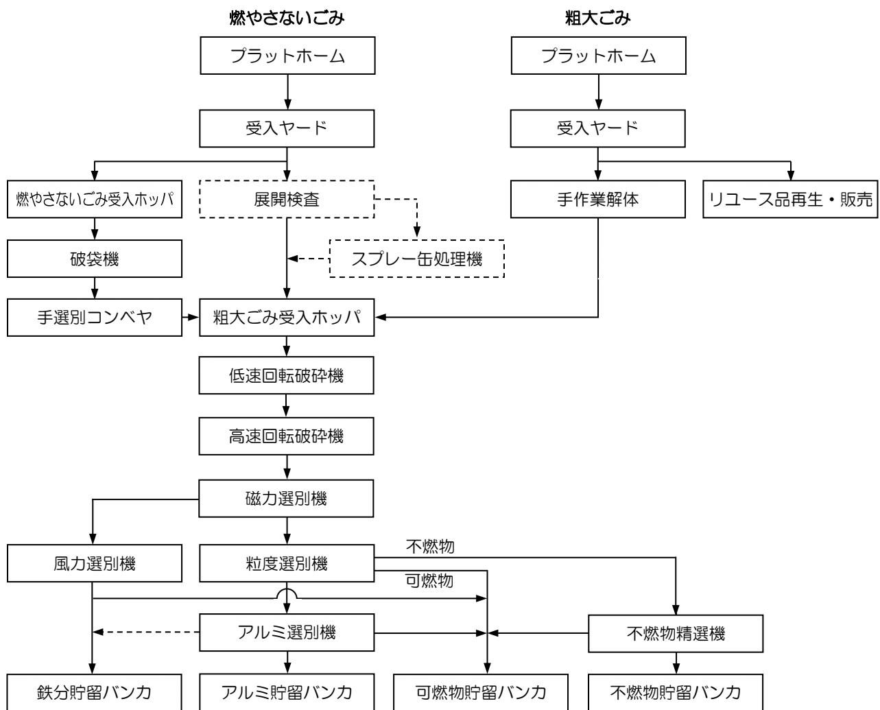
図 3.3-2 燃やさないごみ・粗大ごみ処理フロー（破碎・選別処理あり）
