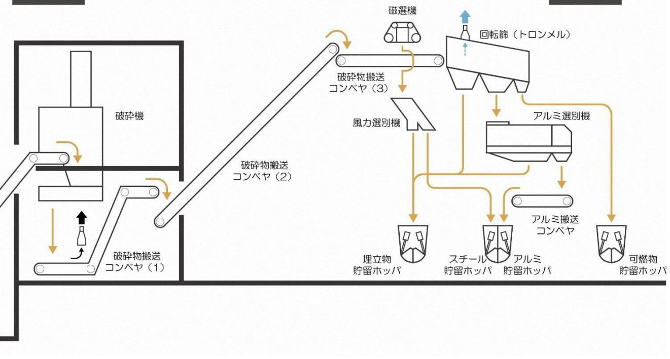
図 2.2-2 中間処理場 処理フロー
