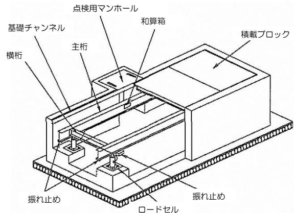
図 3.4-1 ロードセル式計量機（ピット式）
