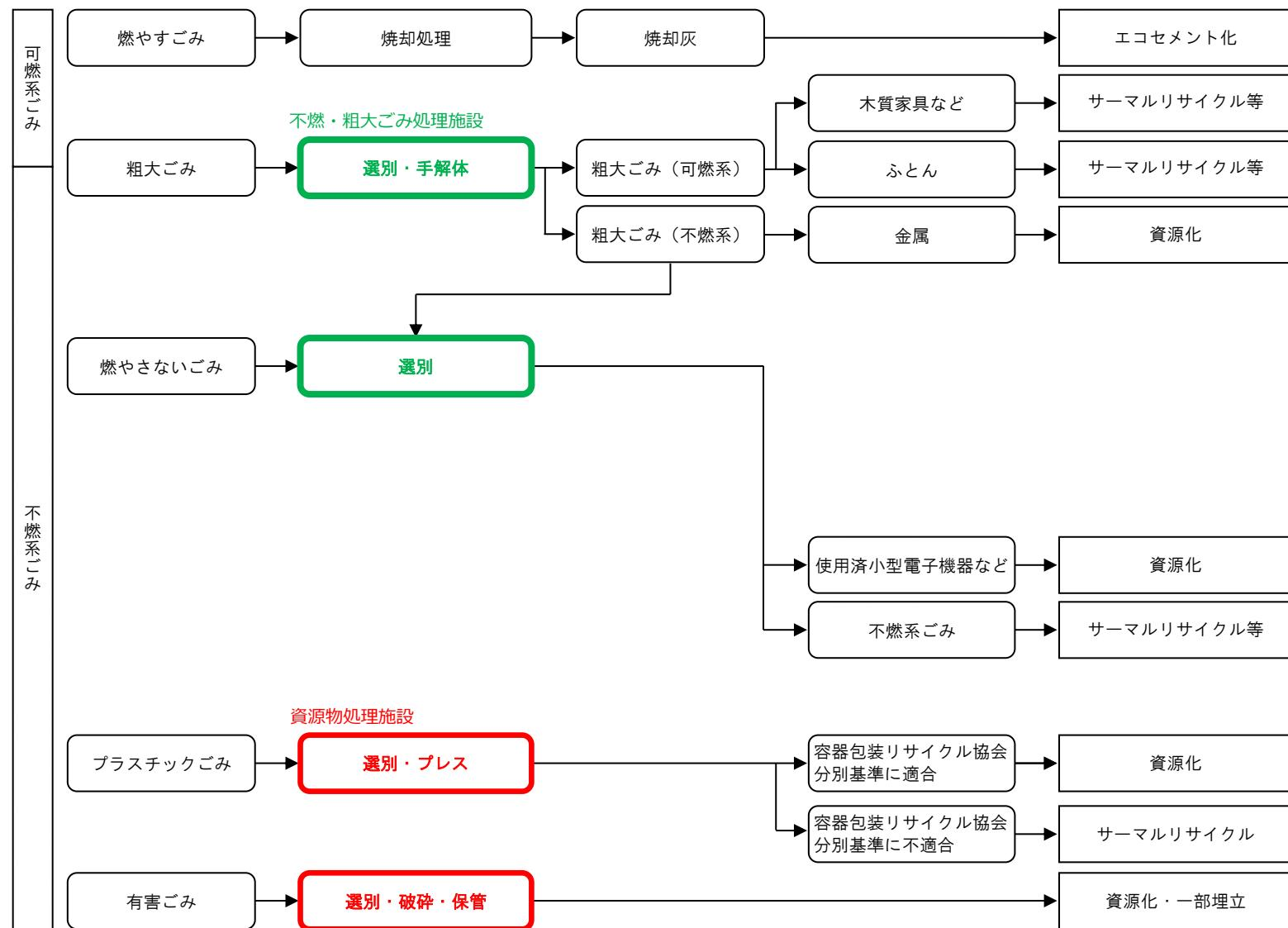
図 2.3-2 ごみ処理フロー（計画案：不燃・粗大ごみを民間処理施設に委託処理する場合：その 1）※赤色・緑色太線：対象ごみ理処理施設
