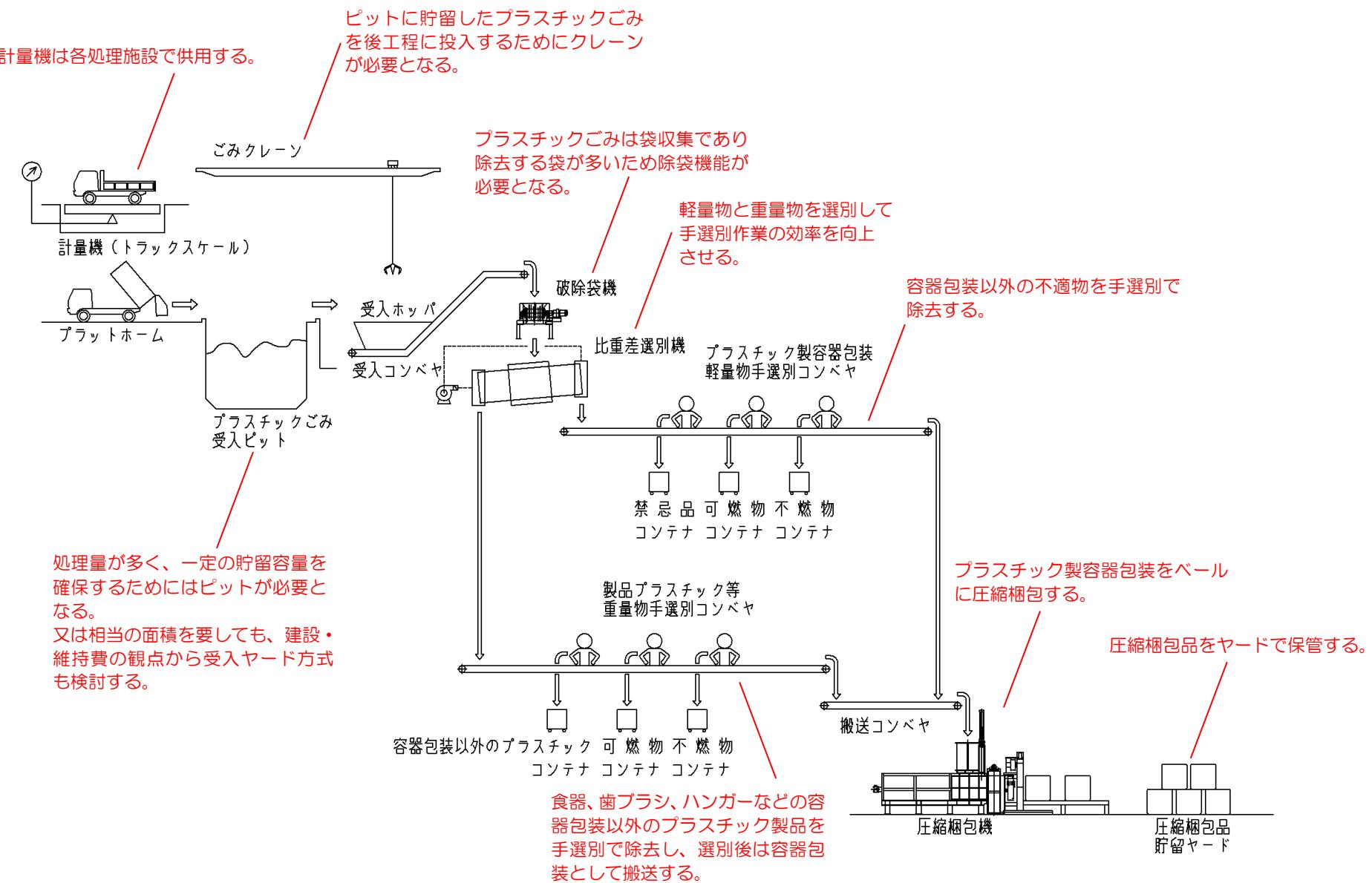
図 3.4-8 プラスチックごみ処理フロー（参考）
