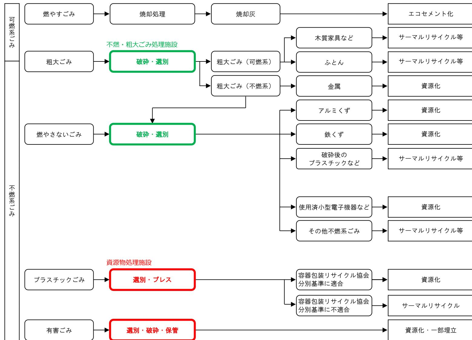
図 2.3-1 ごみ処理フロー（計画案：不燃・粗大ごみを破碎・選別処理する施設を設置する場合：その 1）※赤色太線：対象ごみ処理施設
