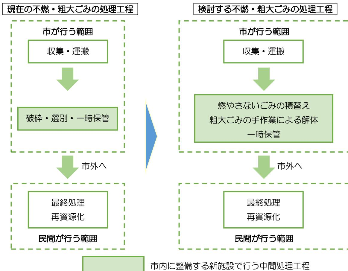
図 3.3-1 不燃・粗大ごみの中間処理工程
