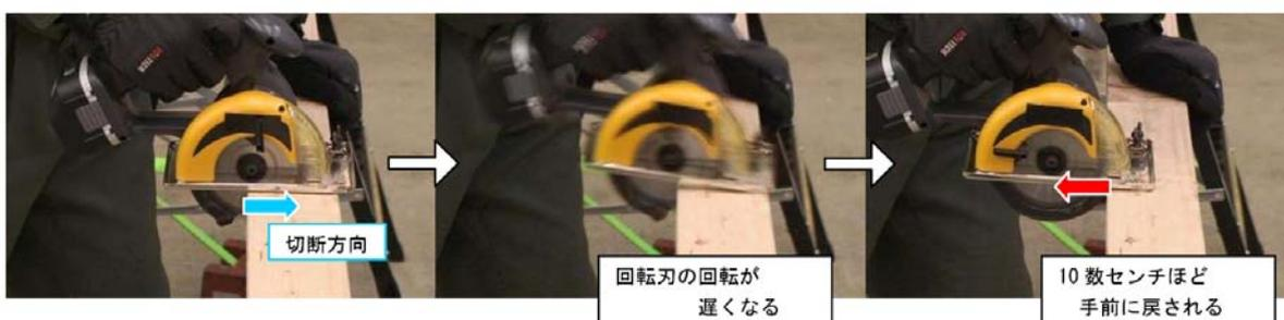
写真2 電動丸のこが材料に挟まった瞬間、手前に戻る様子
