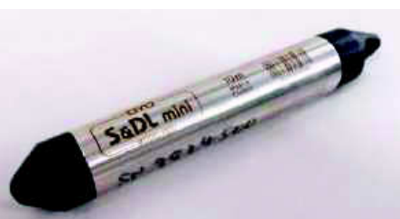
地下水位を自動測定する 自記水位計
