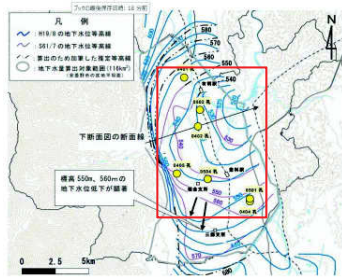
現地調査に基づく地下水水位等高線の作成例
