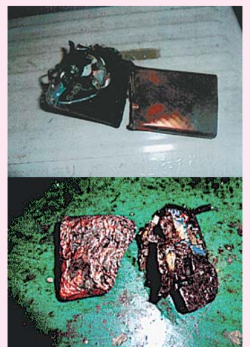
市内で回収したプラスチックごみに混入され発火した電池類
