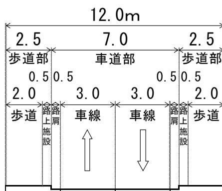
図 3-52 地域的な道路の評価幅員の例
