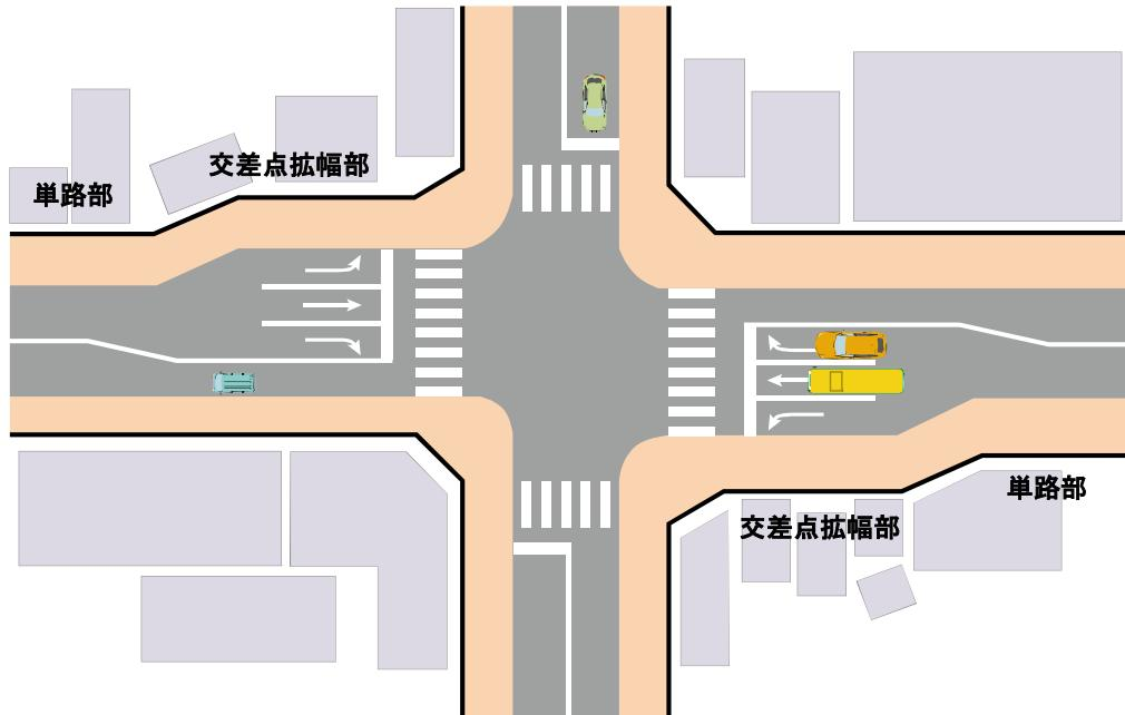
図 3-28 交差点拡幅部のイメージ
