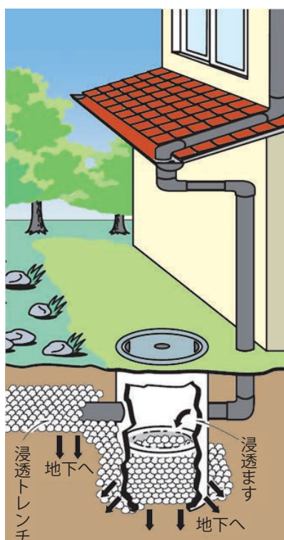
雨水浸透ます
